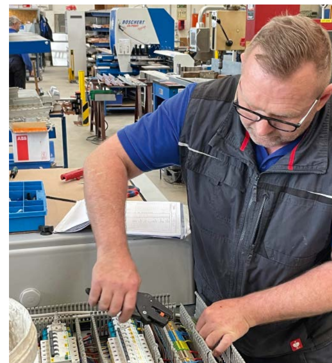
Niederspannungsschaltanlagen werden in der Werkhalle am Hirtenweg von gut geschulten Mitarbeitern auf individuellen Kundenwunsch von A bis Z montiert und geprüft.
