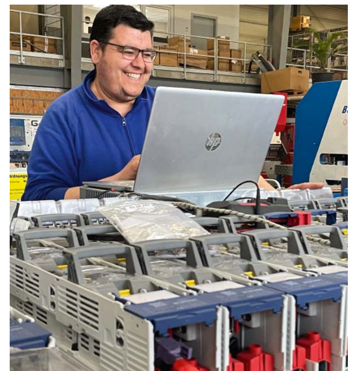
Niederspannungsschaltanlagen werden in der Werkhalle am Hirtenweg von gut geschulten Mitarbeitern auf individuellen Kundenwunsch von A bis Z montiert und geprüft.
