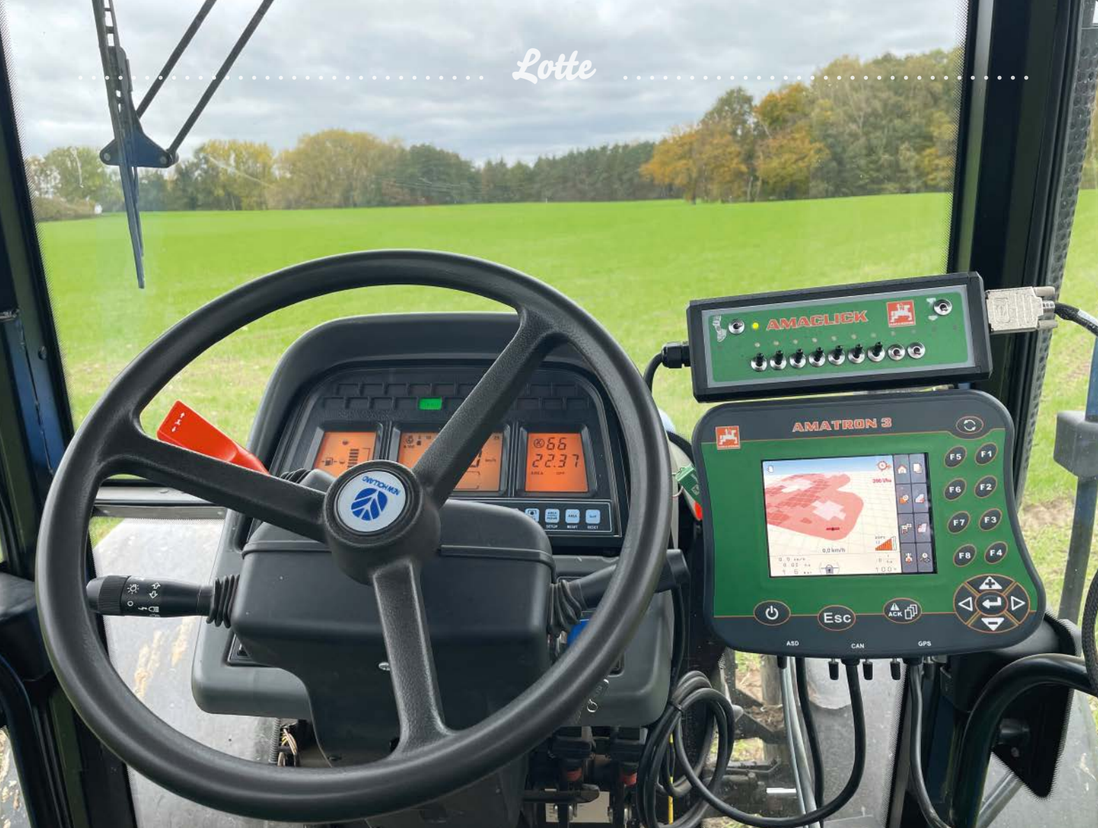
Auch in älteren Traktoren kann mit GPS und Applikationskarten gearbeitet werden.
