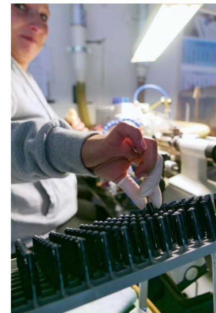
Sarah Reiß dreht sorgfältig die Grate an den Vorderteilen von Füllfederhaltern ab.
