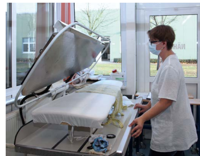
An einer Presse, deren Platte um die 175 Grad heiß ist, werden frisch gewaschene Handtücher, Tischdecken und kleinere Wäschestücke geglättet.
