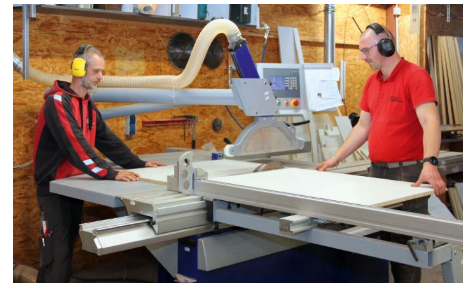
An der elektronisch gesteuerten Säge werden Möbelbauelemente zugeschnitten.
